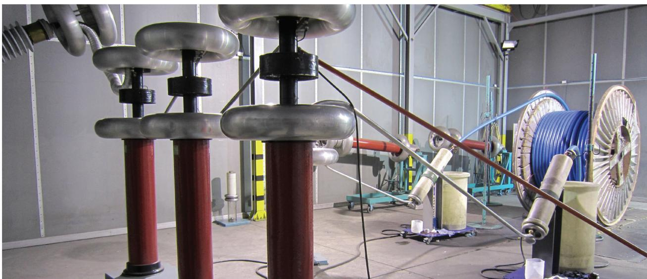
Pruebas de calidad aplicadas a cables de media y alta tensión en la jaula de Faraday de la planta de Cerrillos.
