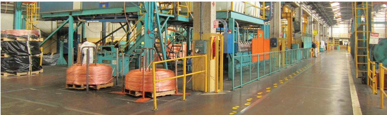
Alambón de cobre entrando a proceso de trefilación.
